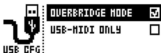
Zweitens - Wechseln Sie mit Ihrem Analog Heat in den Overbridge Mode. Sie finden diese Einstellung unter **SETTINGS > SYSTEM > USB CONFIG**. Drücken Sie **[YES]**, um das Feld **OVERBRIDGE** anzuwählen. Weitere
