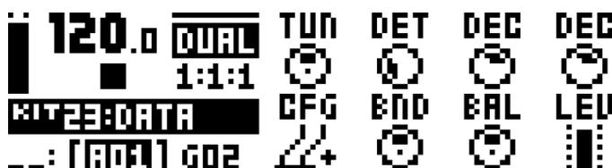
**TUN** (Osc 1 Tune) : オシレーター 1 のチューニングを設定します。値 0 は、音符 C-2 に相当します。1 オクターブは、24 単位に相当します。(-64 ~ +63)
