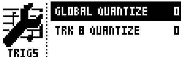
**GLOBAL QUANTIZE:** すべてのトラックのすべてのマイクロタイミングトリガーに適用されます。クオンタイズ値を高くすると、すべてのマイクロタイミングトリガーのクオンタイズ量が大きくなります。0 ~ 127 の範囲で設定します。
