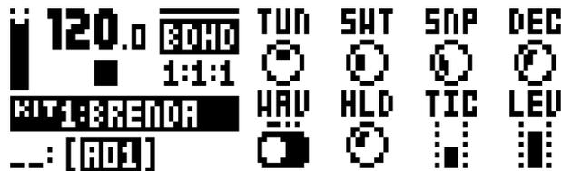
**TUN** (調) : 電圧制御オシレーターのピッチをクロマチックの半音階に設定します。(-64 ~ +63)
