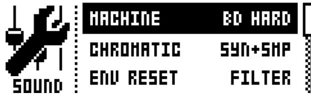
**MACHINE:** アクティブなトラックのサウンドの生成に使用する MACHINE を選択します。アクティブなトラックで使用できる MACHINE のみが表示されます。MACHINE を素早く変更するには、最初の [PARAMETER] キー、SYNTH を 2 回素早く押します。MACHINE の詳細については、90 ページの「付録 D: MACHINES」を参照してください。
