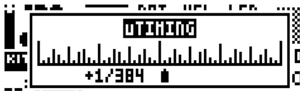
**[TRIG]** キーを押したまま **[ARROW]** キーの **[UP]/[DOWN]** を押してリトリガー速度を設定します。同様に、ポップアップメニューが画面に表示され、ここで各種のリトリガー設定を行えます。リトリガーに関するメニューの詳細については、36 ページを参照してください。
