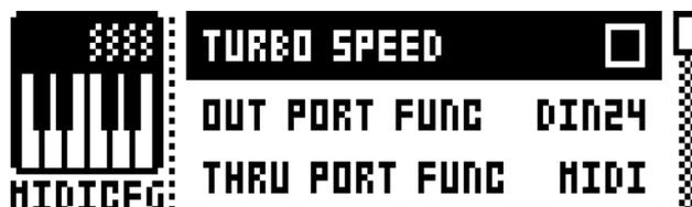
**TURBO SPEED:** [YES/SAVE] を押すと、ターボ速度のネゴシエーションを開始します。速度が自動的に選択されます。ターボ MIDI プロトコルに対応している MIDI インターフェイスを使用してください。
