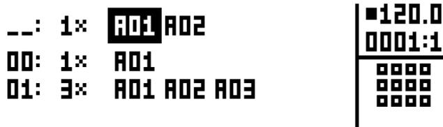
ソングは、上から下に向かって、1行ずつ再生されます。ソングの行にはチェーンがあり、チェーンのすべてのパターンが再生されると、ソング再生位置が次の行に移動します。ソング再生位置のパターン番号が反転表示されます。LCD画面の右上隅に、BPM と再生中の小節数と拍数が表示されます。
