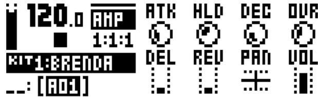
**ATK** (アタック) : アンプエンベロープのアタックフェーズの長さを設定します。(0 ~ 127)
