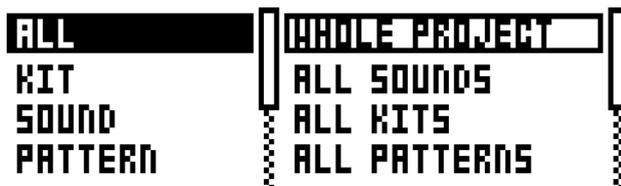
左列で、バックアップする内容を選択します。**[LEFT]**矢印キーで列を選択します。**[UP]/[DOWN]**矢印キーまたはLEVELノブで、列をスクロールします。右列にあるSysExデータ送信項目は、左列で選択した内容によって変わります。この列にアクセスするには、**[RIGHT]**矢印キーを押します。**[UP]/[DOWN]**矢印キーまたはLEVELノブで、送信する内容を選択します。**[YES/SAVE]**を押して、SysEx送信を開始します。
