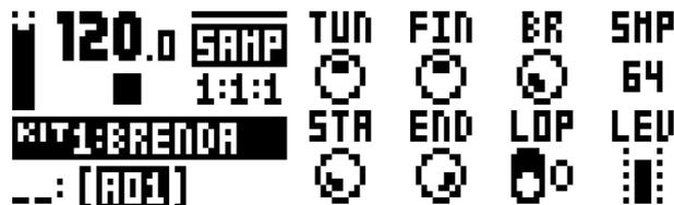
**TUN** (調) : サンプルのピッチをクロマチックの半音階相当で設定します。設定値の進みを速くするには、ノブを押しながら回します。ノブは二極ノブです。真上が 0 で、ピッチは変更されません。(範囲 -24 ~ + 24、4 オクターブ相当)
