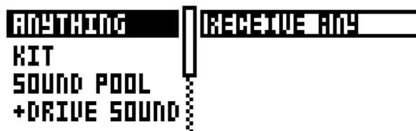
左列で、受信する内容を選択します。[LEFT] 矢印キーで列を選択します。[UP]/[DOWN] 矢印キーまたは LEVEL ノブで、列をスクロールします。右列にある SysEx データ受信項目は、左列で選択した内容によって変わります。この列にアクセスするには、[RIGHT] 矢印キーを押します。[UP]/[DOWN] 矢印キーまたは LEVEL ノブで、受信する内容を選択します。[YES/SAVE] を押して、SysEx 受信を開始します。Analog Rytm が受信データの待機を開始します。待機を中止するには、[NO/RELOAD] を押します。
