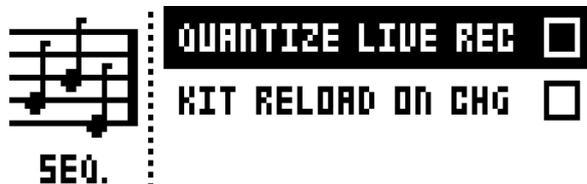
**QUANTIZE LIVE REC:** 有効にすると、LIVE RECORDING モードで入力したノートをクオンタイズしてシーケンサーステップを完了します。設定を無効にすると、ライブ録音したノートに、該当する箇所ではマイクロタイミングが適用されます。マイクロタイミングの詳細については、44 ページの「11.7 TRIG メニュー」を参照してください。
