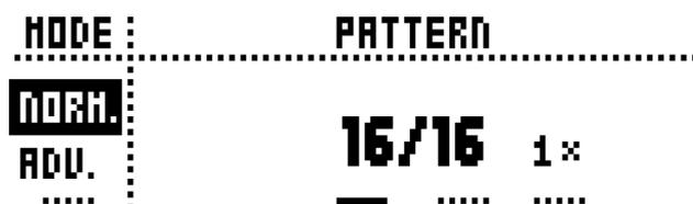
最初の 2 つの設定で、パターンのステップの長さを制御します。左端の番号で、パターンのステップ数を選択します。パターンで使用可能なステップの最大数は、右側のパラメータで設定した合計の長さによって決まります。16、32、48、64 ステップのいずれかになります。パターンのステップが 17 以上の場合、GRID RECORDING モードで [PAGE] キーを使ってパターンページを切り替えます。
