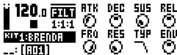
**ATK** (アタック) : フィルターエンベロープのアタックフェーズの長さを設定します。(0 ~ 127)
