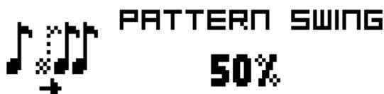
スイング率を、LEVEL ノブを回すか [ARROW] キーの [UP]/[DOWN] を押して 51～80% の範囲で設定します。デフォルト設定は等間隔の 50% です。<TRIG>LED が点灯しているスイングパターンを [TRIG] キーでカスタマイズします。
