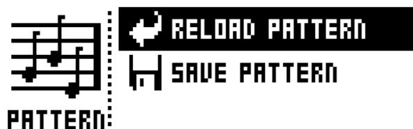
**RELOAD PATTERN:** アクティブなパターンをリロードします。元の自動保存された状態、または **SAVE PATTERN** コマンドで保存した特定の状態をリロードすることができます。[NO/RELOAD] と [SCENE] を押すと、即時に **RELOAD PATTERN** コマンドを実行できます。
