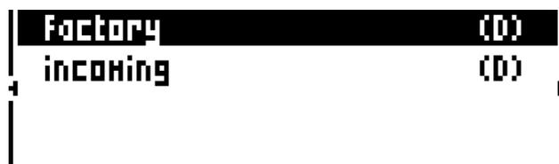
サブディレクトリを開くには、**[ARROW]** キーでハイライトして **[YES/SAVE]** を押します。ディレクトリを閉じるには、画面最上部の「..」という項目を選択して **[YES/SAVE]** を押します。これを繰り返すことで、ディレクトリ階層の一番上まで戻ることができます。サンプルファイルとディレクトリを区別するため、ディレクトリを閉じる「..」の行も含めたすべてのディレクトリには、行の最後に (D) が付いています。+Drive のディレクトリを参照すると、アクティブなプロジェクトの127個のサンプルスロットのいずれかに割り当てられているサンプルは、次のように、カッコの中にスロット番号が表示されます。
