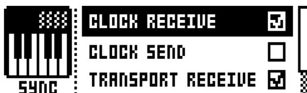
**CLOCK RECEIVE:** 有効にすると、Analog Rytm が外付け機器から送信された MIDI クロックにตอบสนองします。
