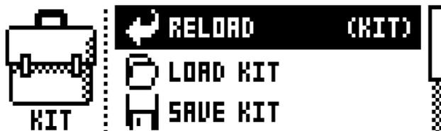
**RELOAD KIT:** アクティブなキットまたはすべてのキットをリロードして保存されている状態に戻します。[LEFT] および [RIGHT] キーで、アクティブなキットのみをリロードするか、すべてのキットをリロードするかを選択します。[NO/RELOAD] + [KIT] を使用すると、アクティブなキットをリロードできます。
