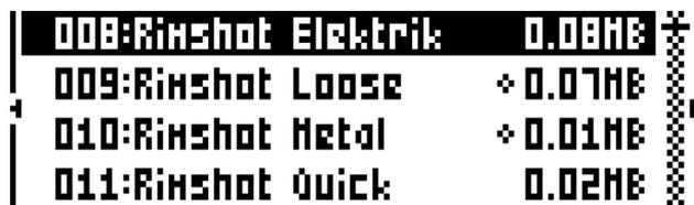
この画面では、127個のユーザーサンプルを個別にアンロードしたり、まとめてアンロードしてスロットを空にできます。**[ARROW]** キーの **[UP]/[DOWN]** または **LEVEL** ノブで、リストをスクロールします。**[YES/SAVE]** を押して個々のサンプルにチェックを付けるか、**[RIGHT]** を押して右側のメニューを表示し **SELECT ALL** を選択します。右側のメニューで、**UNLOAD** を選択するとチェックを付けたサンプルのスロットが空になります。
