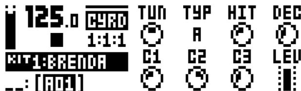
**TUN** (調) : ライドシンバルモデルを作りだす、相互に作用するオシレーターのピッチを設定します。(-64 ~ +63)
