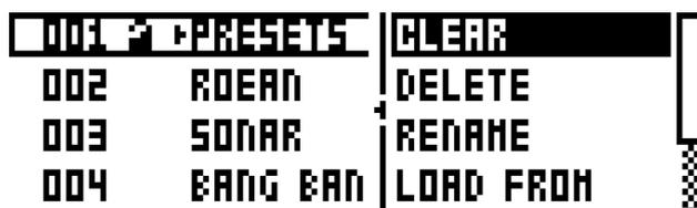
**CLEAR:** プロジェクトのスロットをクリアな状態にリセットします。
