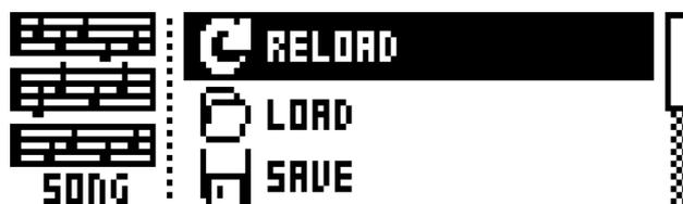
**RELOAD:** アクティブなソングをリロードします。保存済みのバージョンが復元されます。**[NO/RELOAD] + [SONG]** を押しても、この機能を実行できます。
