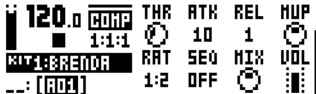
**THR** (スレッシュホールド) : コンプレッサーのスレッシュホールドを設定します。スレッシュホールドを低くすると、信号のより多くの部分にコンプレッションがかかります。LCD 画面の右端にバーが表示され、コンプレッション量をグラフで確認できます。(0 ~ 127)
