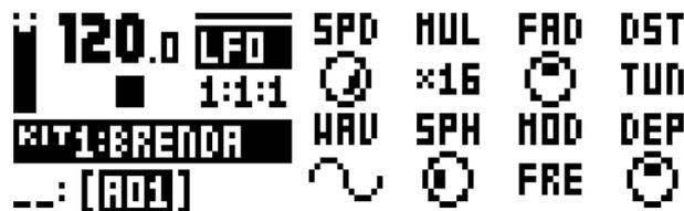
**SPD** (速度) : LFO の速度を設定します。ストレートビートに同期する LFO の場合、設定を 8、16、32 にしてみてください。ノブは二極ノブです。LFO サイクルは、負の値に設定すると逆再生できます。(-64 ~ +63)
