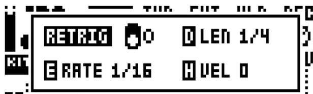
このポップアップメニューは [TRIG] キーを押している間だけ表示されます。リトリガーの有効と無効を切り替えるには、[RETRIG] キーを押すか DATA ENTRY ノブ A を回します。リトリガー率を設定するには、[ARROW] キーの [UP]/[DOWN] を押すか DATA ENTRY ノブ E を回します。DATA ENTRY ノブ D を使用して、リトリガーのベロシティカーブの長さを変更します。リトリガーのベロシティカーブは、DATA ENTRY ノブ H を使用して設定します。ノブは、-128 ~ 127 の範囲の二極ノブです。ベロシティ値を負に設定すると、リトリガーは設定した値までフェードアウトし、正に設定するとフェードインします。このメニューのリトリガー設定は、RETRIG メニューにも表示されます。ただし、シーケンサー
