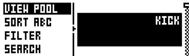
**POOL:** アクティブなプロジェクトのサウンドプールで使用できるサウンドが表示されます。このコマンドは、+Drive サウンドライブラリの参照時にのみ使用できます。
