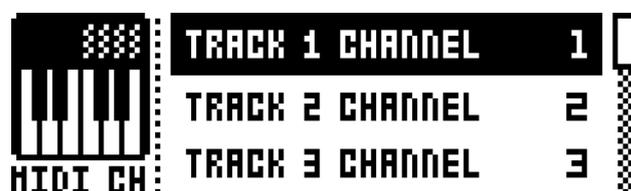
**TRACK 1-12, FX:** ドラムおよび FXトラックを制御する専用 MIDIトラックを選択します。OFF に設定すると、トラックは入力 MIDI メッセージを無視します。
