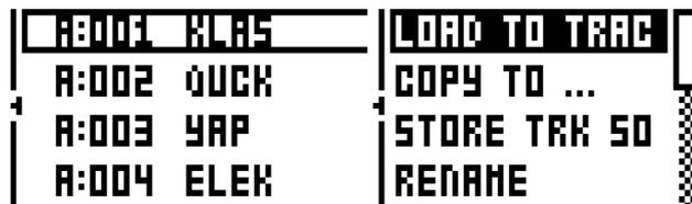
**LOAD TO TRACK:** 選択したサウンドをアクティブなトラックにロードし、アクティブなキットの一部にします。
