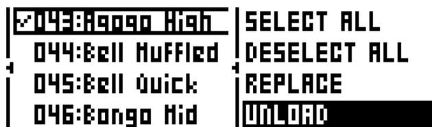
RAMのサンプルをどれでも、それぞれ置き換えることができます。置き換えるサンプルが保存されているスロットをハイライトして、**[RIGHT]** を押して右側のメニューを表示し、**REPLACE** を選択します。+Driveのディレクトリを参照し、目的のサンプルを探して **[YES/SAVE]** を押すと、その前にハイライトしていたサンプルスロットにそのサンプルが配置されます。+Driveストレージのディレクトリを参照したい場合は、**[LEFT]** を2回押して **VIEW +DRIVE** を選択します。
