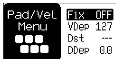
**FIX:** パッドのペロシティを固定に設定します。一定のペロシティでパッドがトリガーされます。また固定ペロシティの値を設定します。OFF: パッドの反応が動的ペロシティに設定されます。(1 ~ 127, OFF)
