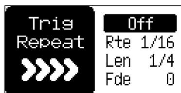
**ON/OFF:** 選択したトリガーのリトリガー機能のオン / オフを切り替えます。
