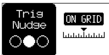
1. GRID RECORDING モードで、1つまたは複数の [TRIG] キーを押したままにして、**SWING** を回すと、TRIG NUDGE メニューが表示されます。ここでは、アクティブなトラックの選択したシーケンサートリガーのタイムオフセットが表示されます。
