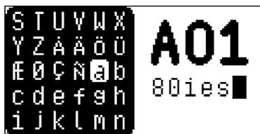
名前付けメニューでは、**LEVEL/DATA** ノブを回して文字の位置を移動します。**[FUNC]** を押したまま **LEVEL/DATA** ノブを回すと、ハイライトされている位置の文字が選択されます。
