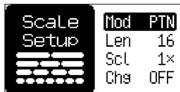
**MOD:** モードを PATTERN または TRACK のいずれかに設定できます。PATTERN モードでは、すべてのトラックで同じ SCALE と LENGTH の設定を共有します。TRACK モードでは、すべてのトラックに個別に SCALE と LENGTH 設定を設定できます。スケールを設定するトラックは、**[T1 ~ 6]** を押して選択します。
