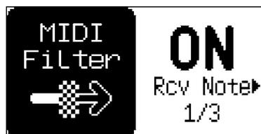
**RCV NOTE:** アクティブにすると、外付け MIDI キーボードまたはコントローラーを使用して Model:Cycles を演奏できます。
