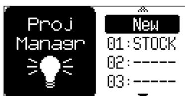
PROJECTを選択すると、プロジェクトマネージャーが表示されます。プロジェクトの管理と、プロジェクトの作成、ロード、クリア、保存ができます。数字が反転表示されているプロジェクトがアクティブなプロジェクトです。**LEVEL/DATA**でプロジェクトを参照し、**LEVEL/DATA**を押すと、以下のオプションがポップアップメニューで表示されます。
