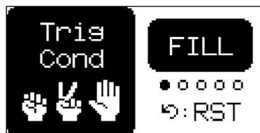
条件付きロックは、特殊なパラメーターロックです。条件付きロックでは、任意のトリガーに複数の条件付きルールを設定することができます。これらの条件付きルールをトリガー条件と呼びます。これは、シーケンサーで設定されたトリガーをトリガーするかしないかを決定する論理条件です。条件が真の場合、トリガーが発動し、トラックに適用されます。
