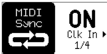
**CLK IN** を ON に設定すると、Model:Cycles は外部機器から送信される MIDI クロックおよび MIDI トランスポートメッセージに反応します。
